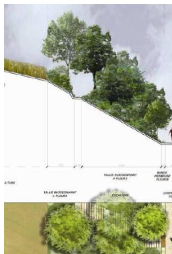
Figure 53 : Plantation des talus les plus abruptes
